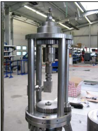
Manipulator-Aufsatz zum Trennen von Rohren (horizontale Schnitte)
