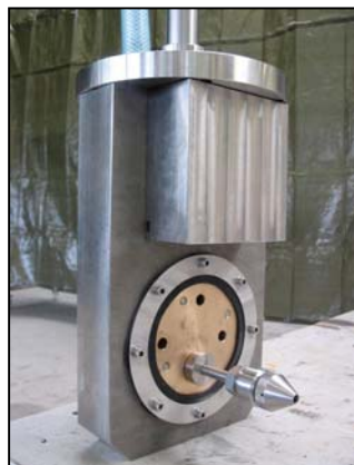
Vorderansicht des Manipulator-Aufsatzes zum Schneiden von Löchern (vertikale Schnitte)
