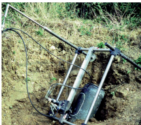
Schneiden eines Ausbrennlochs mit 3-Achsen-Schneidtable
