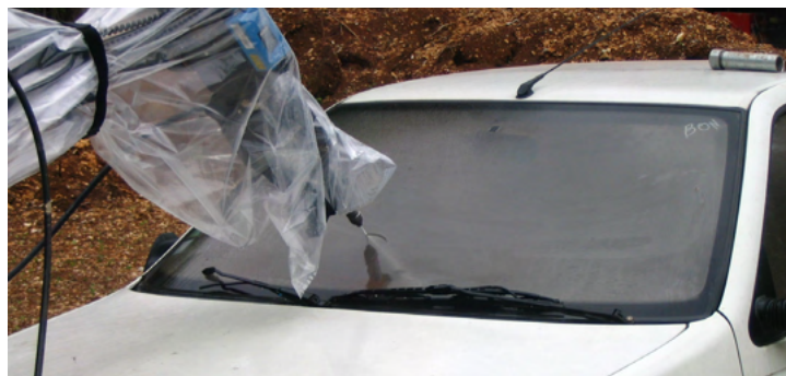
Penetrieren einer Windschutzscheibe
