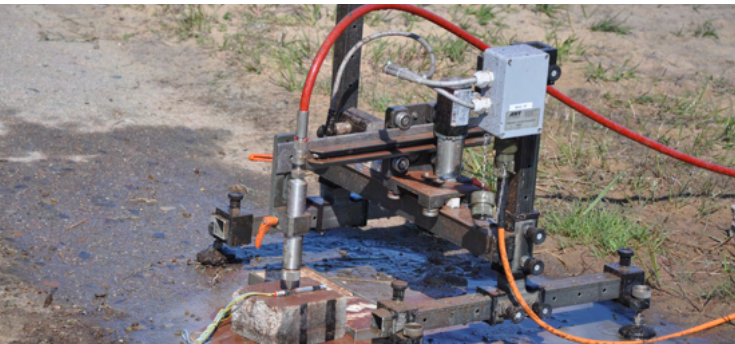
Schneiden eines Zünders mit einem 2-Achsen-Schneidtableau
