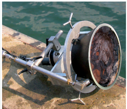
Abgeschnittener Bombenboden nach der Bergung
