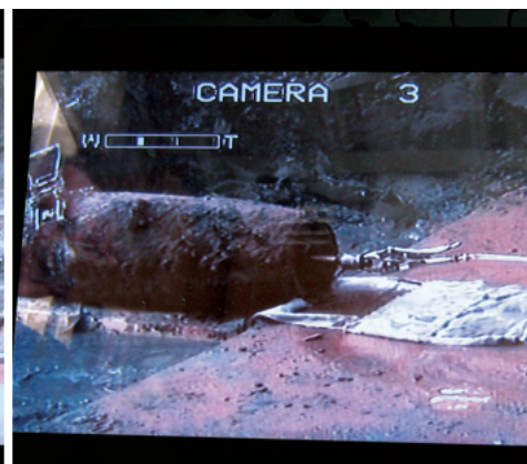
Ziehen des Zünders mit der dritten Achse
