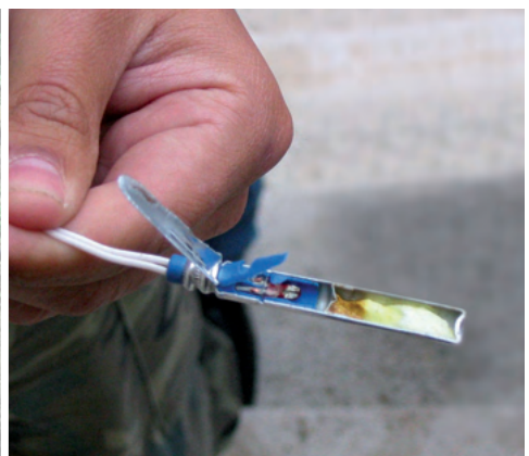
Schnitt durch einen Zünder
