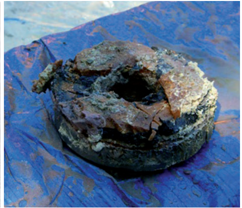
Herausgeschnittener Bombenboden ohne Zünder
