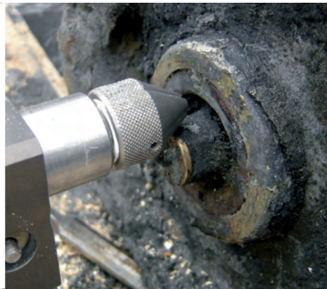
Installation des Schnittführungssystems
