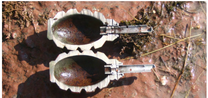
Schnitt durch eine Handgranate
