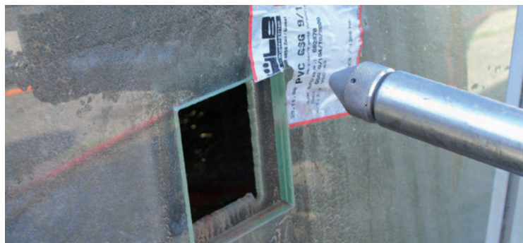
Penetrieren von Sicherheitsglas
