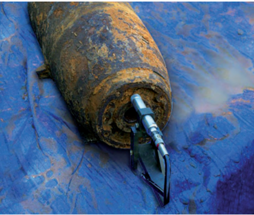
Schneiden mit Multiflex-Kreisschneider
