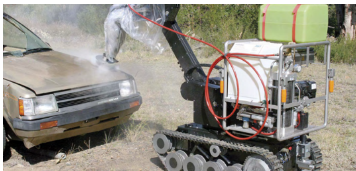
Schneiden einer Öffnung in ein Fahrzeug
