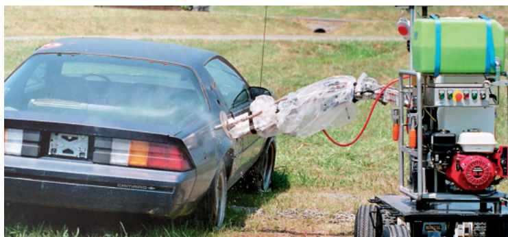
miniMACE im Einsatz mit EOD Roboter
