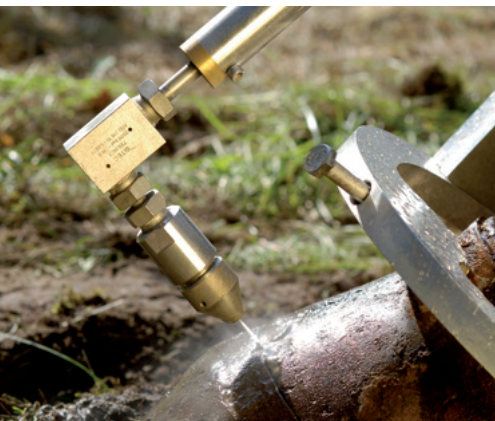
Schneiden mit Base Fuse Manipulator (mit Bombenbodenschneider)
