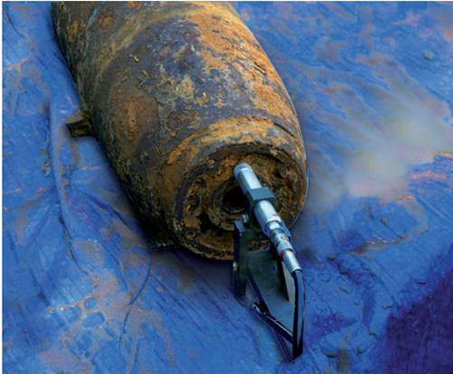
Schneiden mit Multiflex-Kreisschneider
