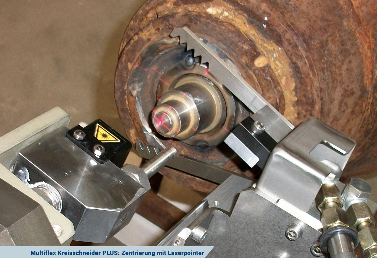
**Multiflex Kreisschneider PLUS: Zentrierung mit Laserpointer**
