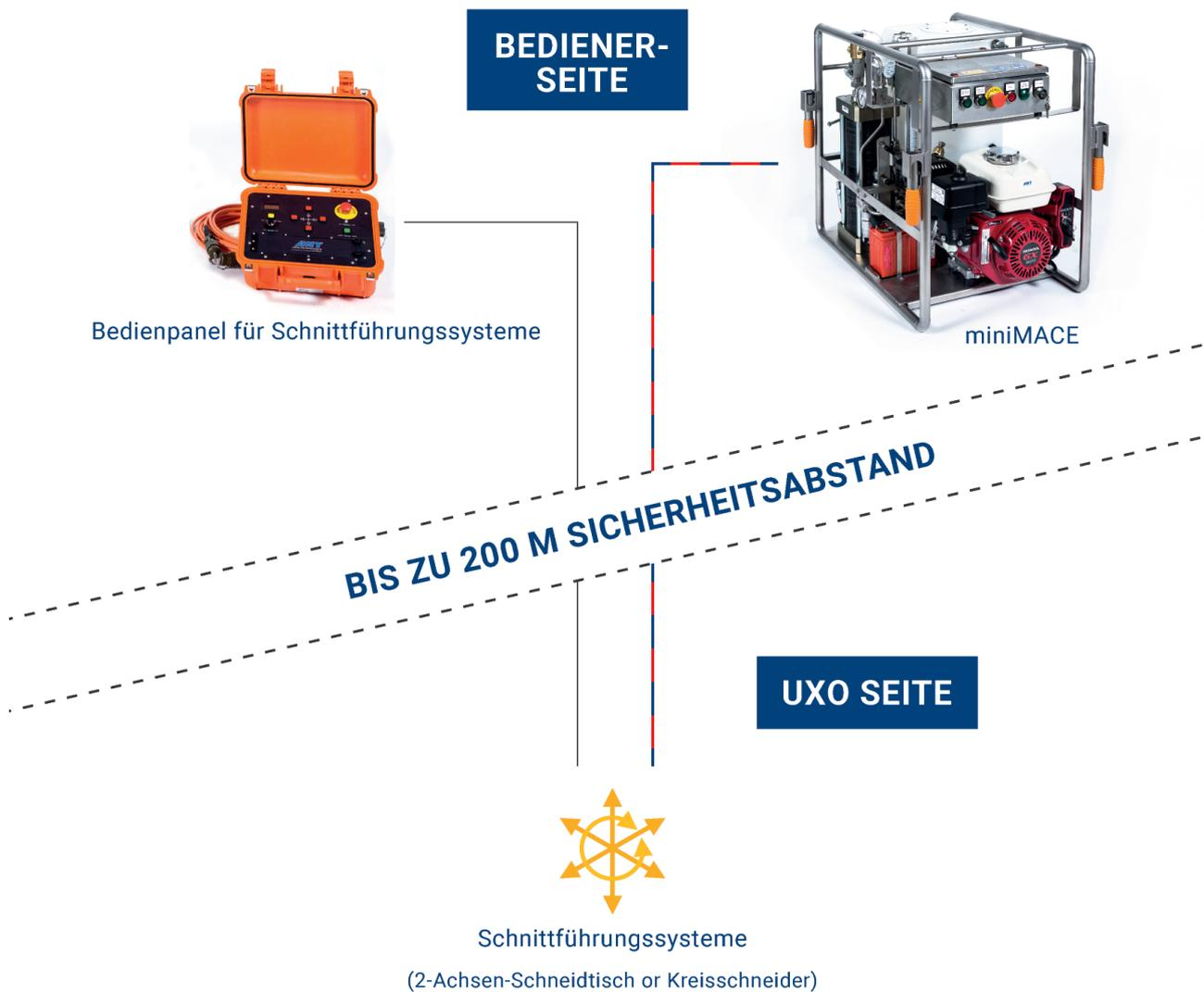
miniMACE ist ein autarkes Komplettsystem mit Verbrennungsmotor, Abrasivmittel-Mischeinheit (AMU) und Hochdruckpumpe (HPP) für den Zugang zu und die Deaktivierung von improvisierten Sprengsätzen (IED).
