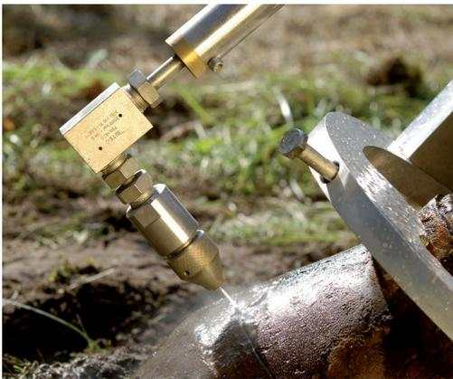
Schneiden mit Base Fuse Manipulator (mit Bombenbodenschneider)
