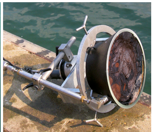
Abgeschnittener Bombenboden nach der Bergung
