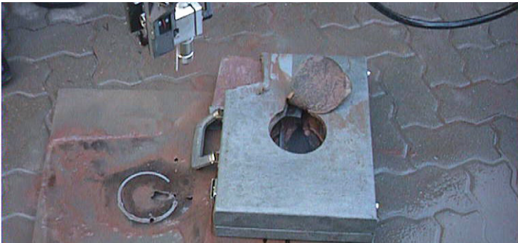
Inspektionsöffnung in einem Koffer
