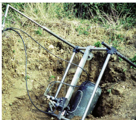
Schneiden eines Ausbrennlochs mit 3-Achsen-Schneidisch
