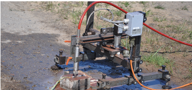
Schneiden eines Zünders mit einem 2-Achsen-Schneidtisch
