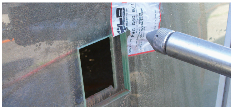
Penetrieren von Sicherheitsglas
