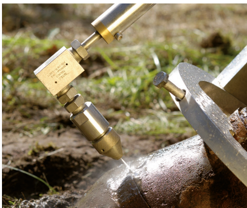
Schneiden mit Base Fuse Manipulator (mit Bombenbodenschneider)
