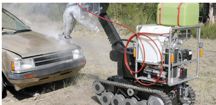
Schneiden einer Öffnung in ein Fahrzeug
