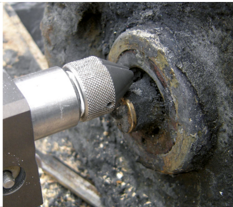
Installation des Schnitfführungssystems
