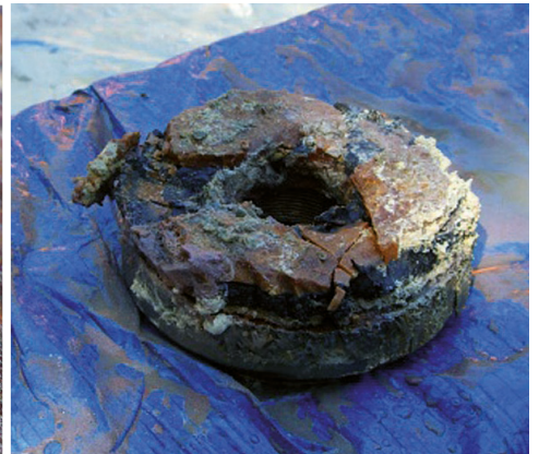
Herausgeschnittener Bombenboden ohne Zünder
