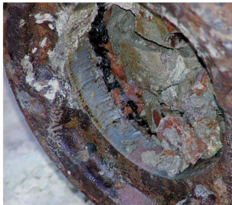
Bombenkörper nach dem Schnitt ohne Boden
