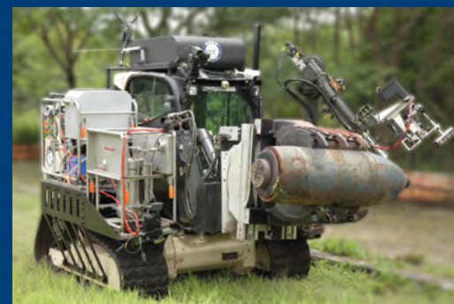
UXOR mit MACE 700bar (Unexploded Ordnance Handling Robot)
